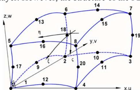
**Figure 1. Isoparametric 20-Nodes-3D-Element [Möller 2003]**
